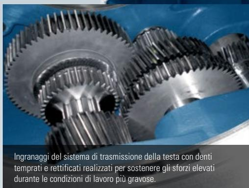
Ingranaggi del sistema di trasmissione della testa con denti temprati e rettificati realizzati per sostenere gli sforzi elevati durante le condizioni di lavoro più gravose.
