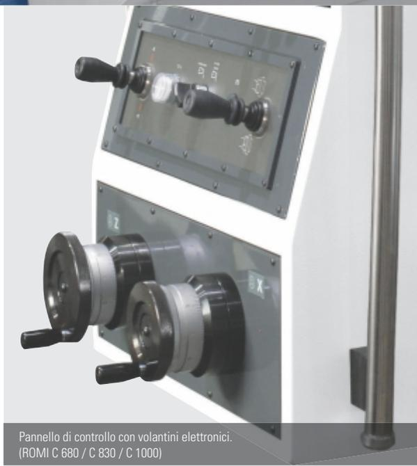
Pannello di controllo con volantini elettronici. (ROMI C 680 / C 830 / C 1000)
