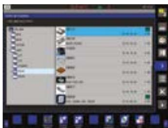
**4.** I programmi di lavorazione possono essere facilmente accessibili e visualizzati in cartelle organizzate, con l'immagine del particolare, il nome e il numero del programma, facilitandone l'identificazione.
