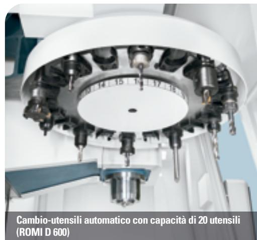
Cambio-utensili automatico con capacità di 20 utensili (ROMI D 600)
