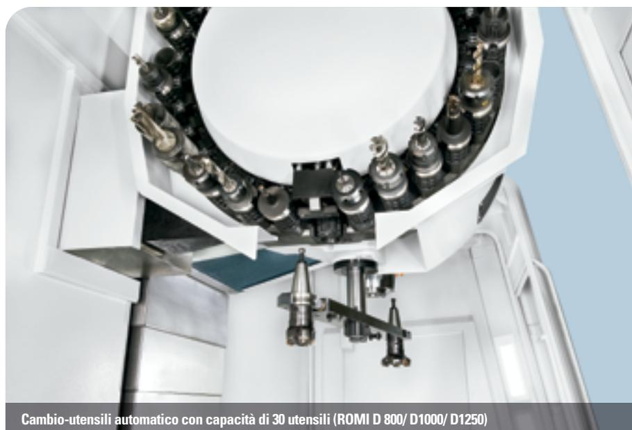
Cambio-utensili automatico con capacità di 30 utensili (ROMI D 800/ D1000/ D1250)
