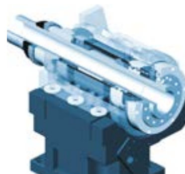
Testa dotata di piastre isolanti, che riducono al minimo il trasferimento di calore dalla cartuccia alla base
