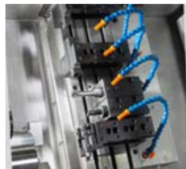
Sistema Gang Tools per i portautensili: inclinazione di 60°, facile accesso dell'operatore ai portautensili ed evacuazione dei trucioli
