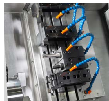
Sistema Gang Tools per i portautensili: inclinazione di 60°, facile accesso dell'operatore ai portautensili ed evacuazione dei trucioli
