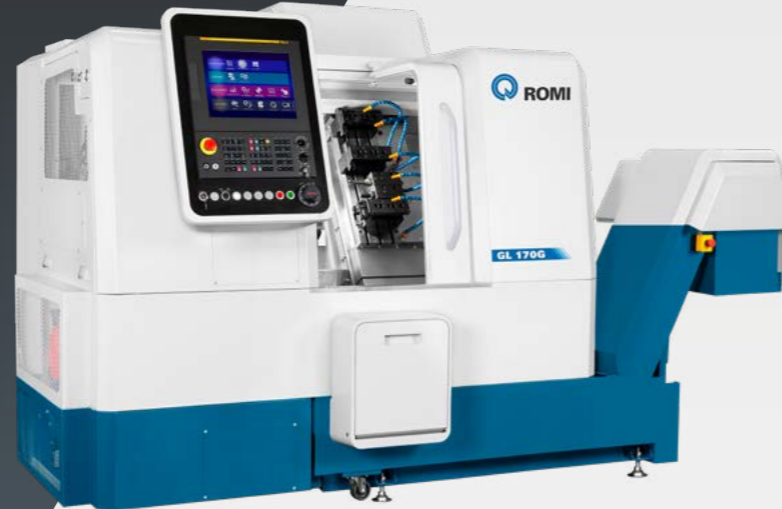
ROMI GL 170G equipaggiata con cassetto estrazione pezzi e trasportatore di trucioli
